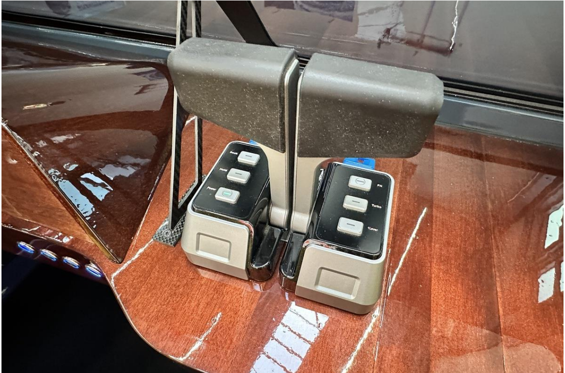
• ... die markanten ePropulsion-Fahrhebel für die beiden Elektromotoren mit jeweils 20 Kilowatt Leistung © Kerstin Zillmer
